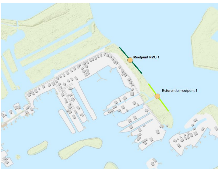
Figuur 3. Aanleg natuurvriendelijke oever (NVO), met referentiemeetpunt en meetpunt in de NVO.
