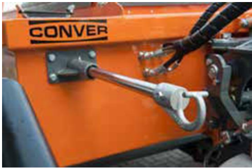
Figuur 7. Aandrijving voor een veegmes achter standaard maaiboot
